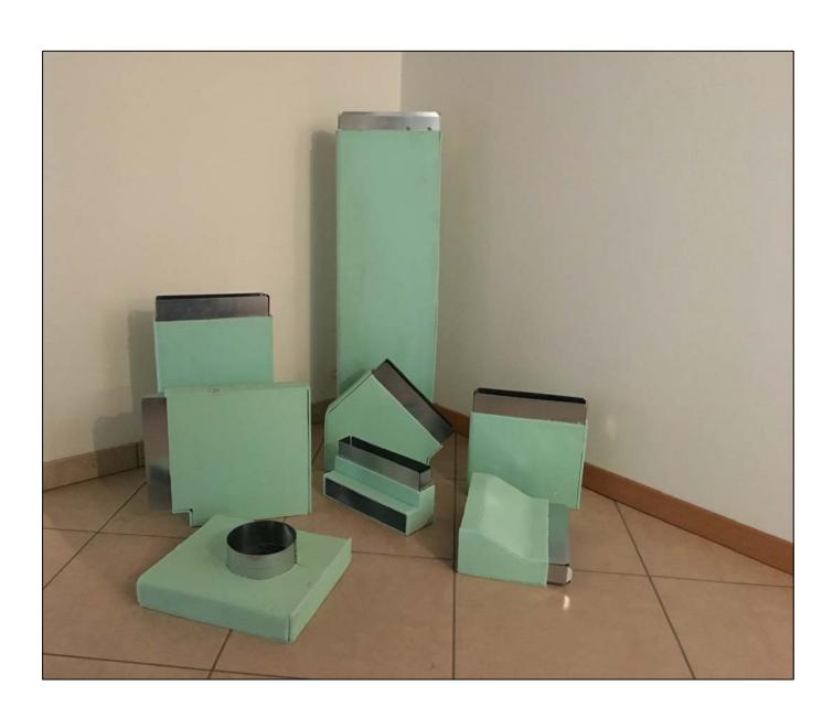
Canale ribassato per installazione a pavimento, realizzato in lamiera zincata 6/10 con giunture ad innesto e rivestimento termoisolante in polietilene sp. 6 mm adatto per realizzare prese aria comburenti per caminetti, stufe a legna e a pellet. Ideale anche per canalizzare l'aria calda.
